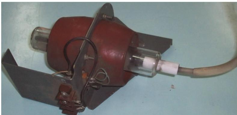
Рис. 2.5. Высокочастотный высоковольтный вакуумный выключатель ВВ-20
