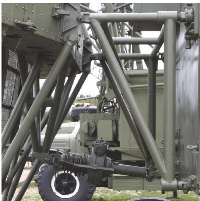
Рис. 3.3. Конструкция крепления отражателей на кабине
