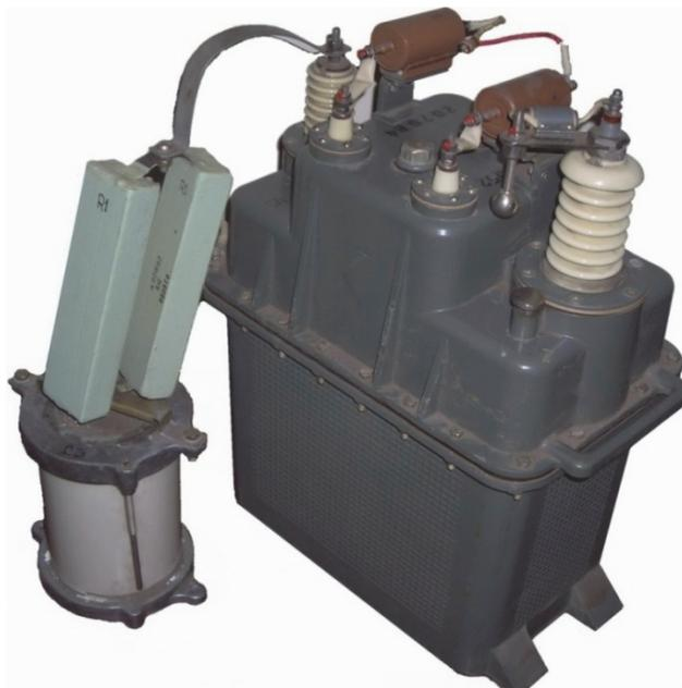
Рис. 2.13. Общий вид импульсного трансформатора
