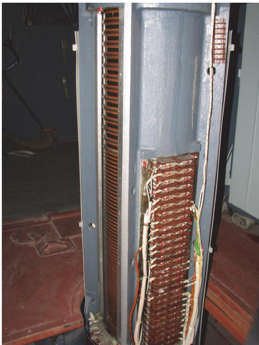
Рис. 7.1. Токосъемник ТК-03/2
