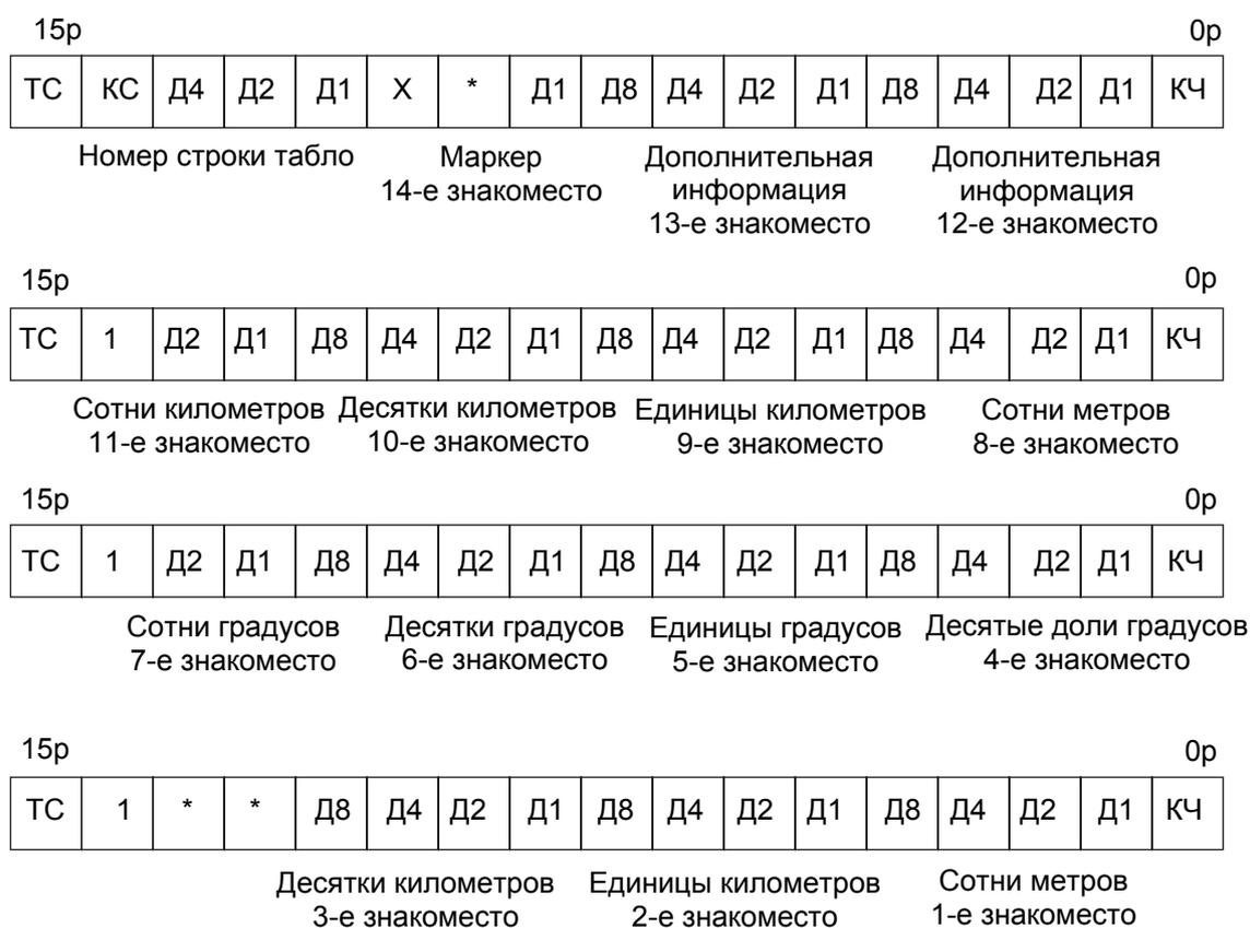
Рис. 9.34. Состав информации, передаваемой для отображения
