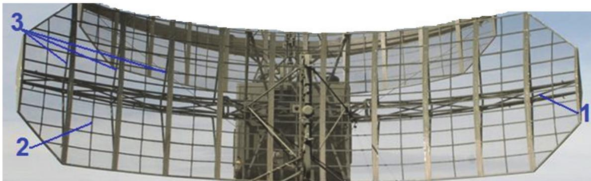
Рис. 3.2. Внешний вид отражателя: 1 – каркас отражателя; 2 – щиты в сборе; 3 – подкосы
