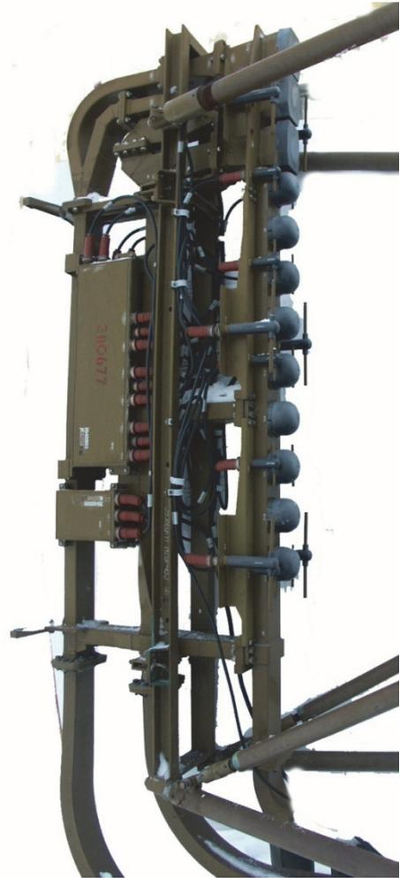
Рис. 3.7. Блок облучателей нижнего отражателя 395ВВ01М
