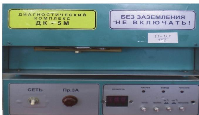
Рис. 3.4. Общий вид малообъемного вискозиметра
