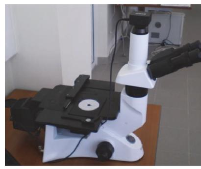
Рис. 3.7. Микроскоп электронный «Альтами» Мет1М
