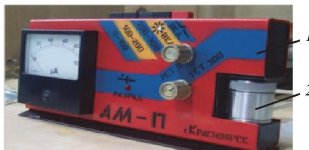
Рис. 3.1. Прибор для определения оптических свойств смазочных материалов: 1 – блок измерения; 2 – фотометрическая кювета
