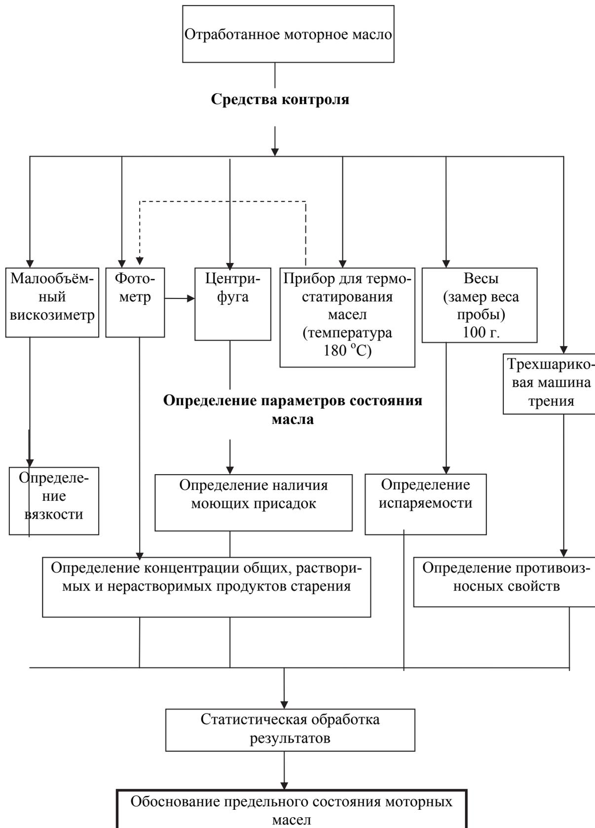
Рис. 6.11. Схема определения и обоснования предельного состояния работающих моторных масел
