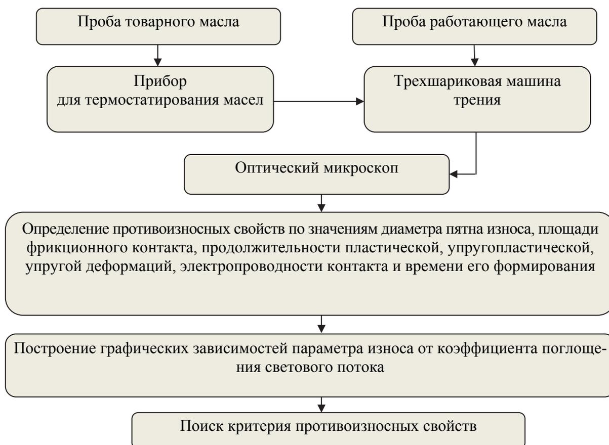
Рис. 3.11. Схема контроля противоизносных свойств трансмиссионных масел
