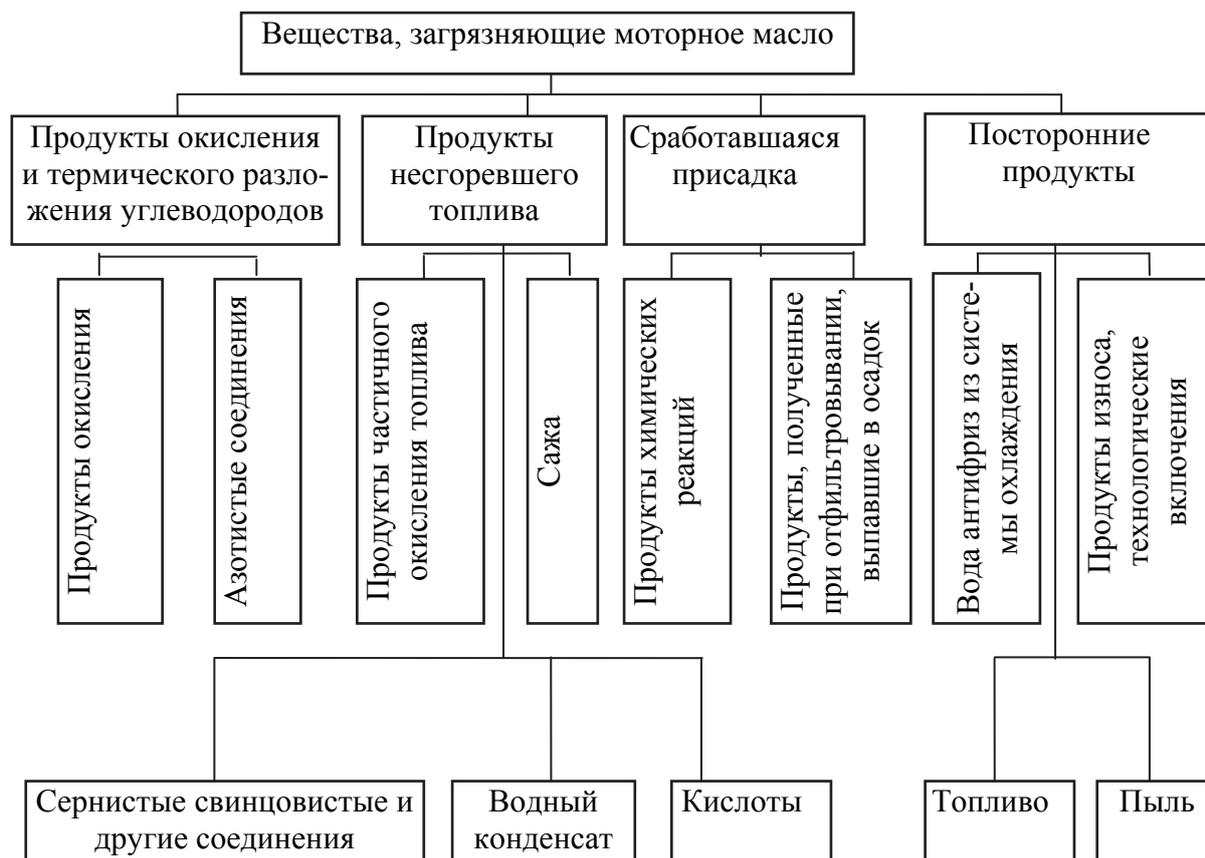
Рис. 6.10. Схема процесса загрязнения (старения) моторного масла
