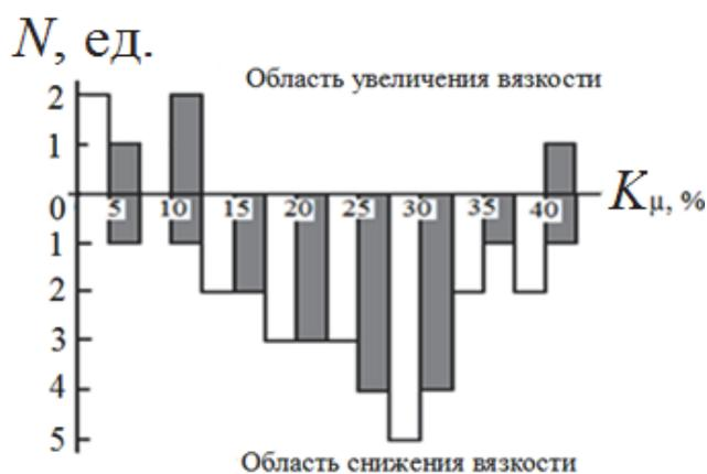
Рис. 5.12. Гистограммы изменения коэффициента относительной вязкости отработанных синтетических моторных масел по отношению к вязкости товарных масел: □ – пробы исходных масел; ■ – пробы окисленных масел в течение 3 часов испытания при температуре 180 °С
