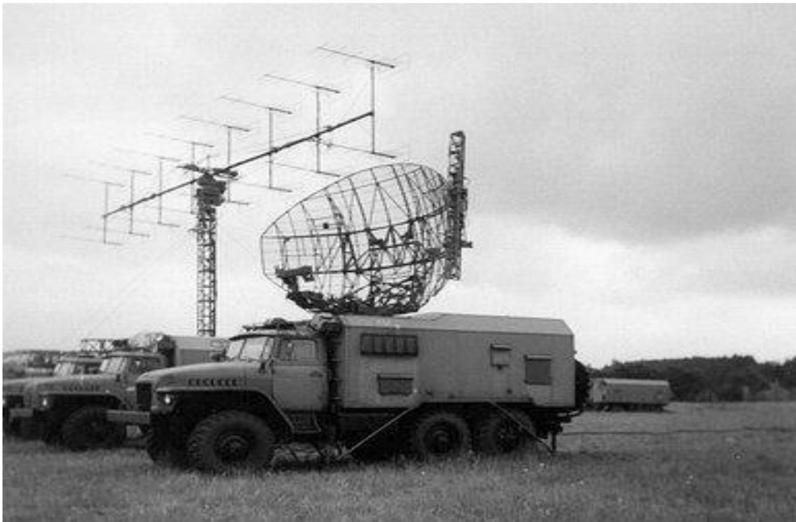
Рис. 1.3. Общий вид радиолокационной станции П-18Р
