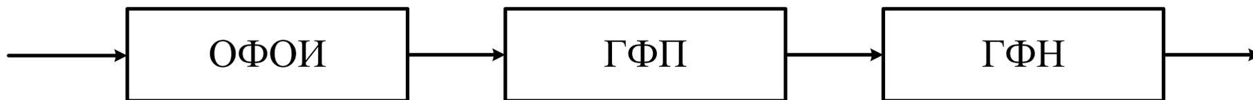
Рис. 3.8. Структурная схема системы оптимальной фильтрации сигналов на фоне отражений от пассивных помех
