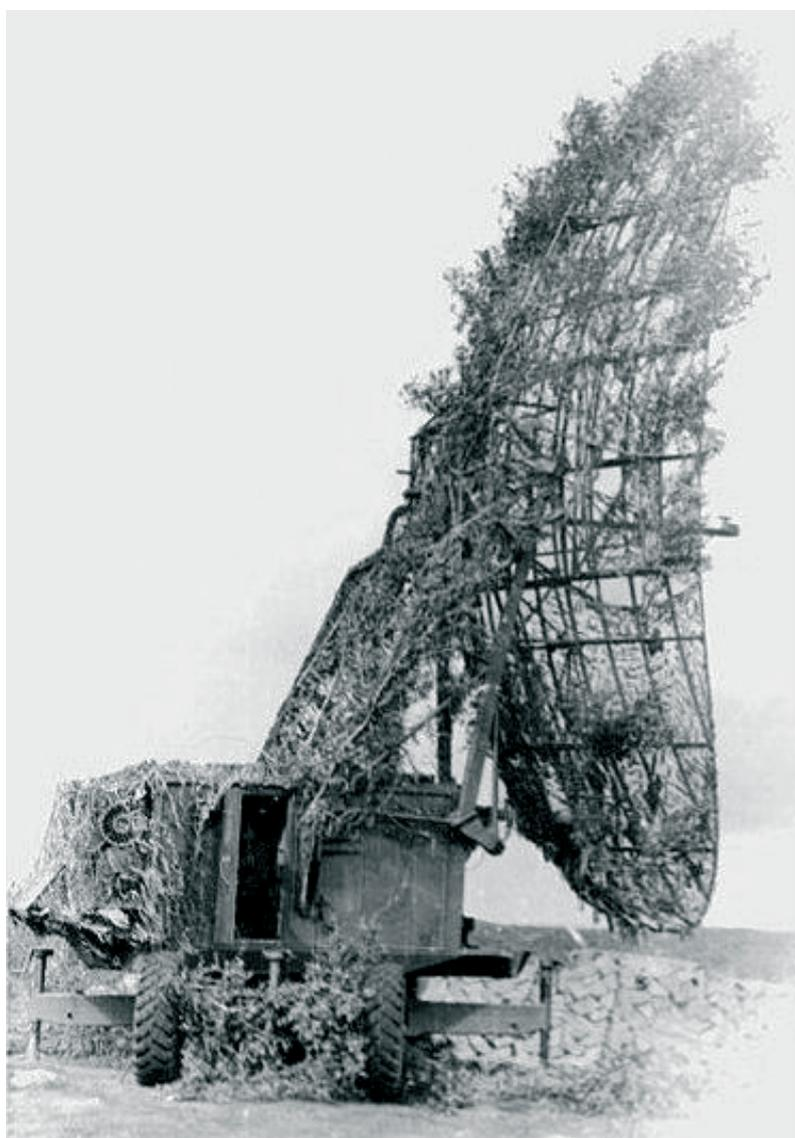
Рис. 11б. Маскировка кабины В-1 табельными средствами (маскировочная сеть) и местные подручными материалами (ветки деревьев)
