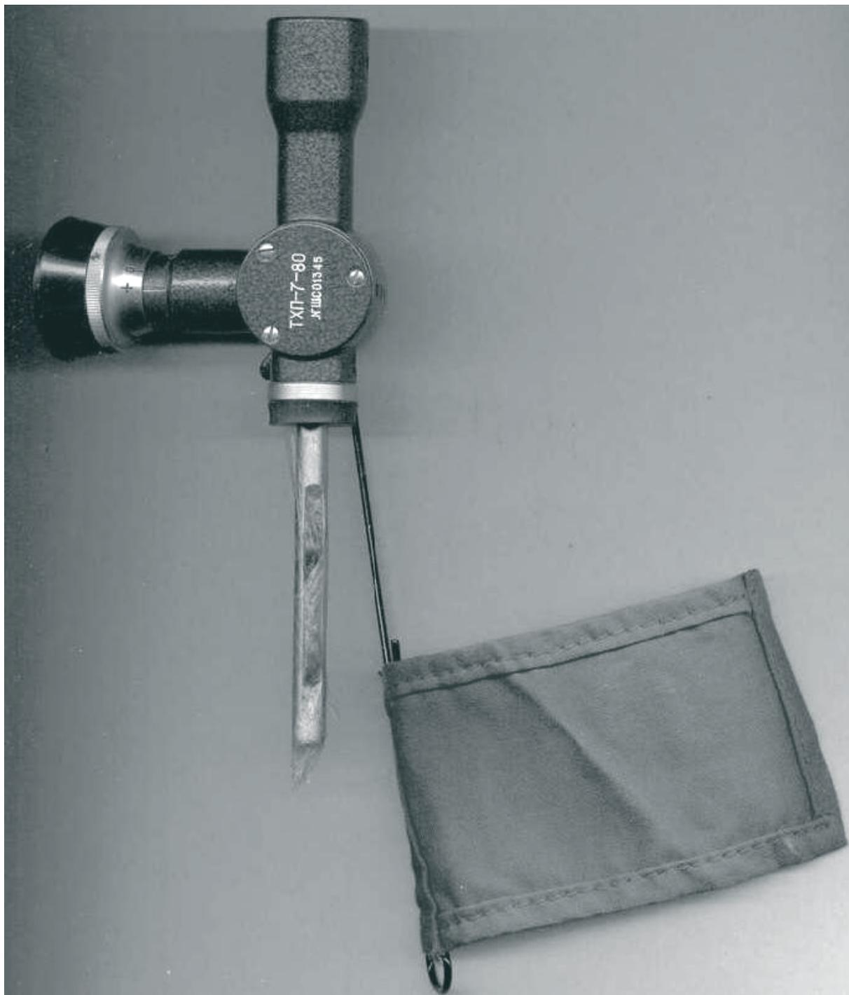
Рис. ПЗ.2 Трубка холодной пристрелки ТХП-7-80
