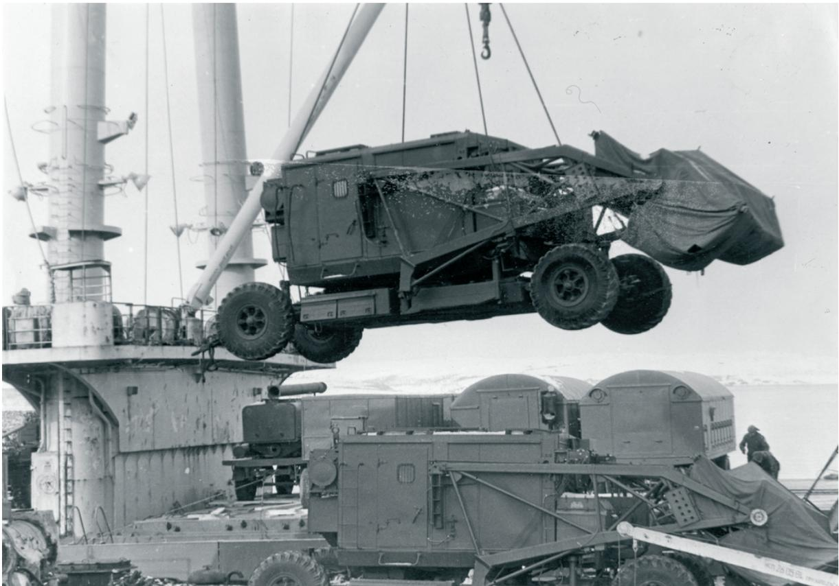
Рис. 10. Погрузка кабины В-1 с обычным (не уменьшенным) габаритом на грузовую палубу корабля
