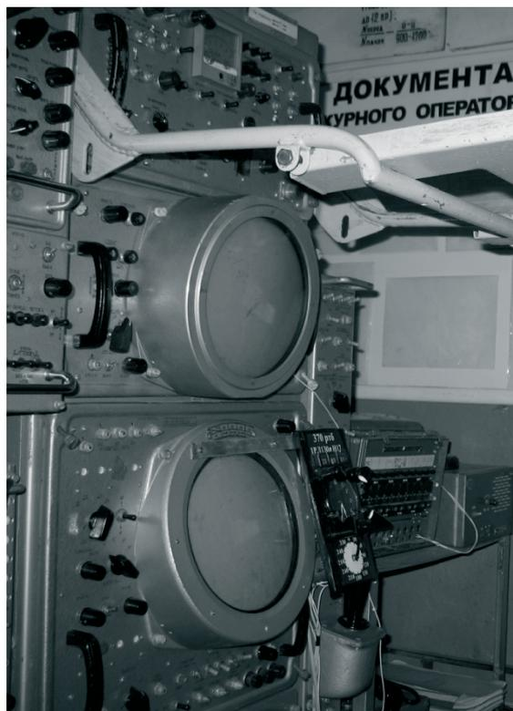
Рис. 2. Индикаторный шкаф И-7 на КП радиотехнического подразделения
