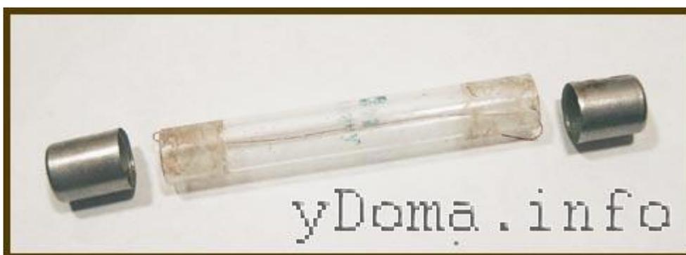
Продеть зачищенную проволочку через трубку по диагонали и надеть на место чашки. Плавкий предохранитель отремонтирован.
