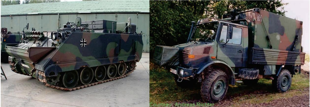
Рис. 14. Автоматизированная система управления огнем полевой артиллерии ADLER II (Artillerie Daten Lage und Einsatz Rechnerverbund) на базе (бронетранспортера) M113 и командно-штатная машина на шасси грузового автомобиля (ФРГ)
