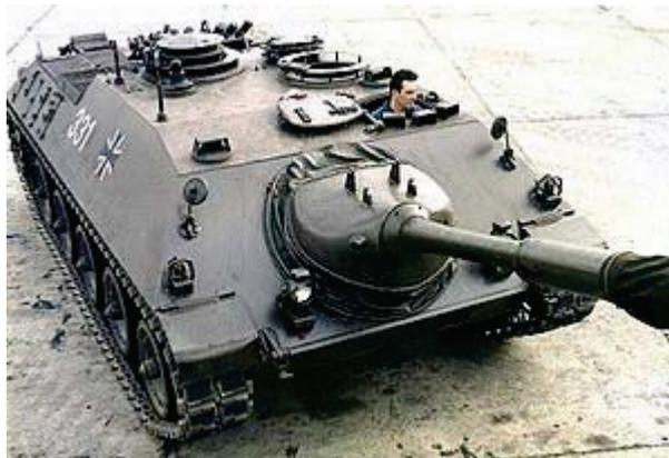
Рис. 8. Самоходная 90-мм противотанковая артиллерийская установка Jpz 4-5 (Германия)
