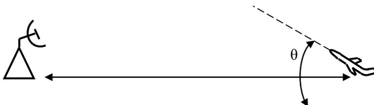
Рис. 2.14. Зависимость величины ЭПР от угла поворота цели относительно направления на РЛС
