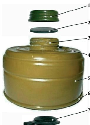
Рис. 4.2. Противогазовая коробка: 1 – металлический колпачок; 2 – резиновая прокладка; 3 – горловина; 4 – крышка корпуса; 5 – цилиндрический металлический корпус; 6 – дно корпуса; 7 – резиновая пробка
