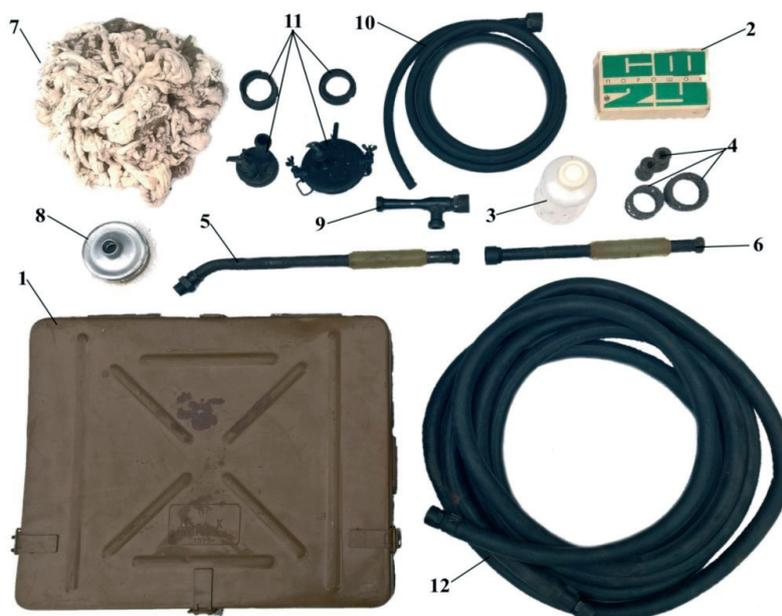
Рис. 7.5. Автомобильный комплект ДК-4К: 1 – ящик; 2 – пакет с порошком СФ-2У (СФ-2); 3 – банка полиэтиленовая; 4 – запасные части; 5 – брандспойт; 6 – удлинитель; 7 – ветошь; 8 – щетка; 9 – эжектор; 10 – рукав жидкостный; 11 – газоотборное устройство; 12 – рукав газо-жидкостный
