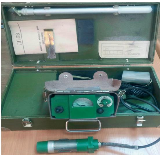
Рис. 6.3. Внешний вид прибора ДП-5В
