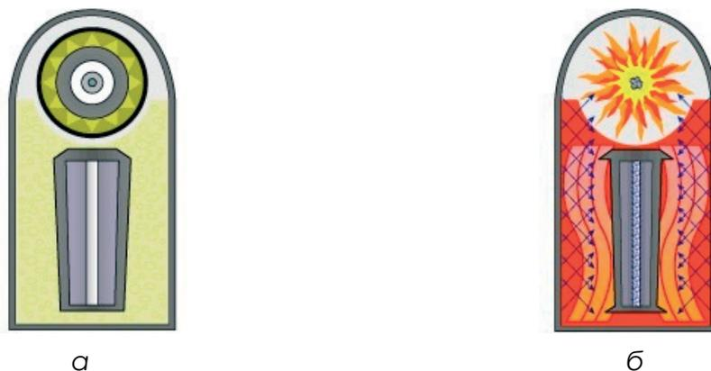
Рис. 1.2. Принципиальная схема осуществления ядерного взрыва с помощью направленного внутрь взрыва обычного ВВ (имплозии): а – плотность нормальная, масса меньше критической; б – плотность больше нормальной, масса больше критической
