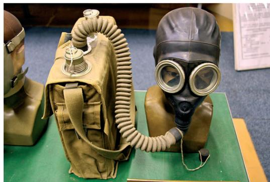
Рис. 4.21. Изолирующий дыхательный аппарат ИП-46
