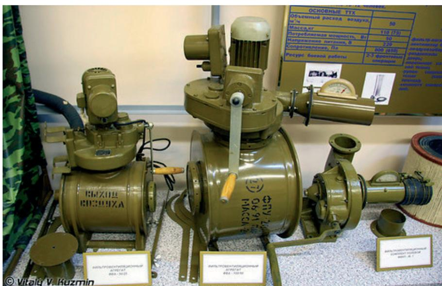
Рис. 5.1. Фильтровентиляционный аппарат ФВА-100/50
