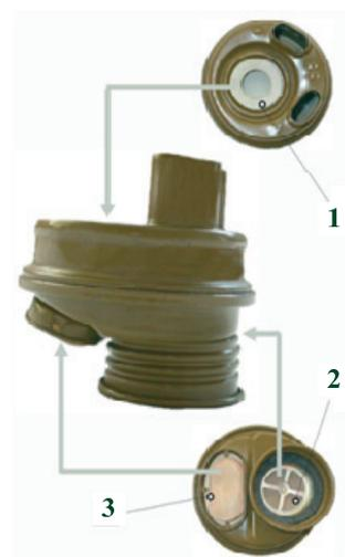
Рис. 4.4. Клапанная коробка противогаза ПМГ-26: 1 – клапан выдоха (основной); 2 – клапан вдоха; 3 – клапан выдоха (дополнительный)
