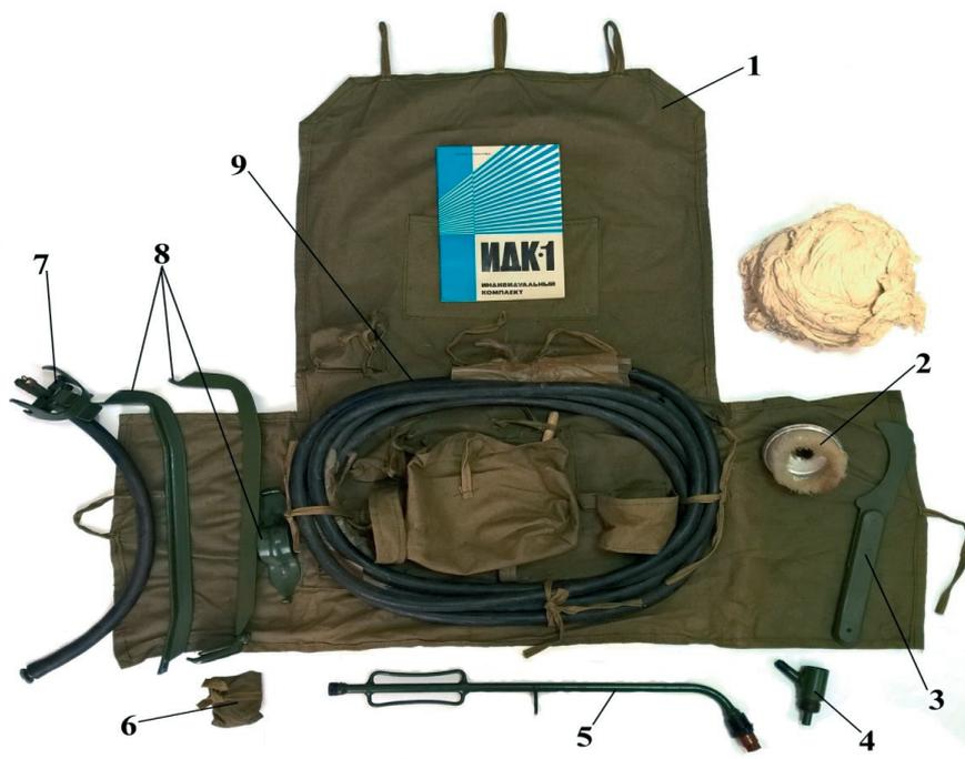
Рис. 7.4. Индивидуальный комплект для специальной обработки ВВТ ИДК-1: 1 – укладочная сумка; 2 – щетка; 3 – скребок; 4 – эжекторная насадка; 5 – брандспойт с распылителем; 6 – комплект ЗИП; 7 – специальная крышка с рукавом и фильтром; 8 – хомут; 9 – воздушный и жидкостный резиновые рукава
