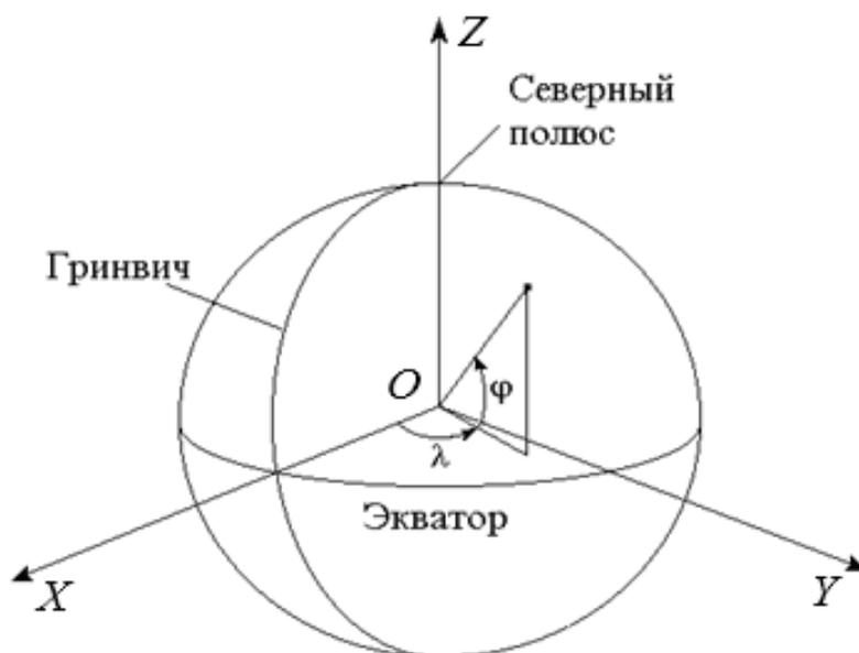
Рис. 1.1. Геоцентрическая система координат
