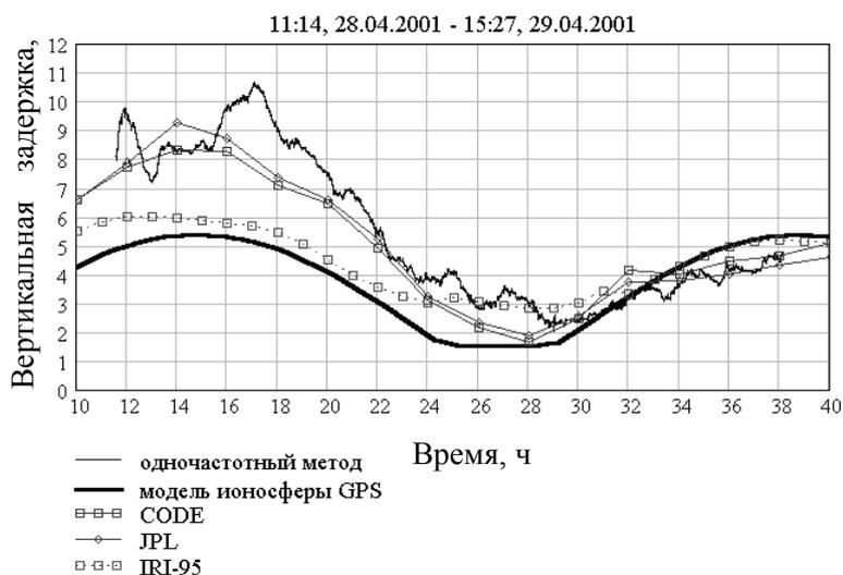
Рис. 1.8. Результаты экспериментальных исследований, проведенных при повышенной геомагнитной активности ( $A_p = 40$  нТ)
