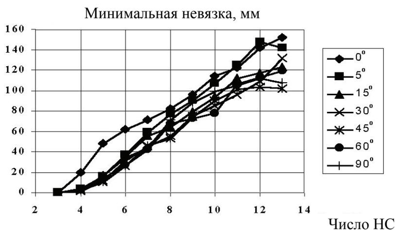
Рис. 3.15. Минимальная невязка при длине баз 5 м
